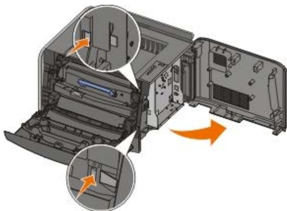
4. Снимите металлическую крышку, ослабив винты и сдвинув крышку влево, и извлеките ее из принтера.
