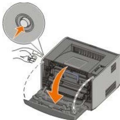
2. Нажмите кнопку блока картриджа с тонером, затем потяните вверх за рукоятку и извлеките блок картриджа.
