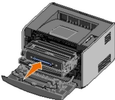
8. После замены фотобарабана необходимо сбросить счетчик фотобарабана. Для сброса счетчика нажмите и удерживайте в нажатом положении кнопку **Отмена**
