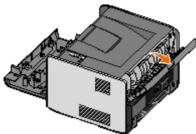
3. Откройте боковую крышку, нажав на две защелки в переднем правом углу устройства и отклонив крышку назад.
