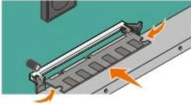
8. С усилием вставьте модуль памяти в разъем до защелкивания в фиксаторах на обоих концах разъема.
