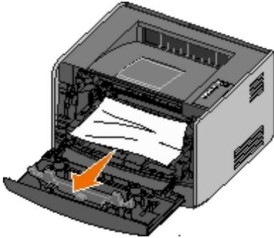
4. Поднимите откидную крышку на передней панели принтера и извлеките всю замятую бумагу, находящуюся под крышкой.
