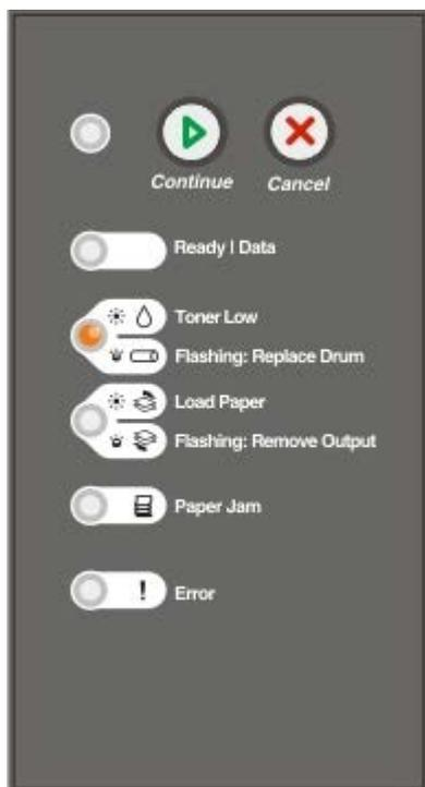
При отображении последовательности индикации **Мало тонера** или при появлении бледных распечаток извлеките картридж с тонером. Несколько раз сильно встряхните картридж в разных направлениях для перераспределения тонера, затем установите его и продолжите печать. Повторяйте эти действия до тех пор, пока они продолжают улучшать качество печати. Если распечатки остаются бледными, замените картридж с тонером.
