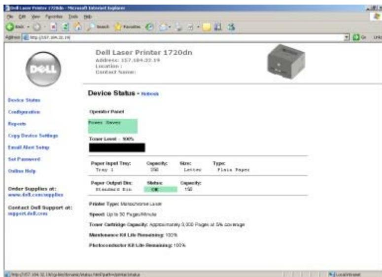
Кроме этого, функции Web-инструмента настройки принтера Dell позволяют изменять параметры принтера и вести статистику эксплуатации принтеров. Сетевой администратор может непосредственно из обозревателя Интернет скопировать параметры одного принтера на другой принтер или на все принтеры, входящие в сеть.
